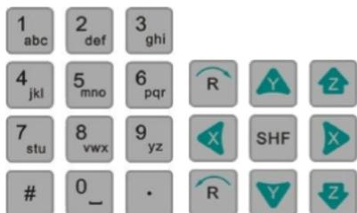
Робот серии TSR2000 предназначен для программирования как с помощью ввода координат (опытные пользователи) так и с помощью кнопок подстройки шага (начинающие пользователи).
