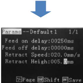
Используйте буквенноцифровые кнопки для изменения скорости отвода, высоты отвода и задержки включения / отключения подачи.
