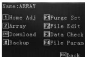
Сразу после завершения обработки координат программы отображается элемент «File Parameters» («Параметры файла») — нажмите **F4**.
