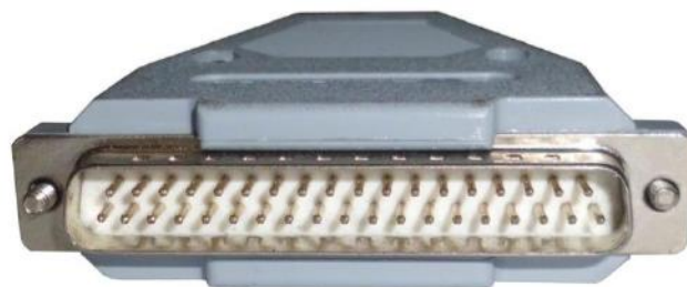
Вилка DB37 (тип контактов)
